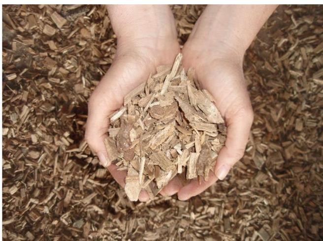
Abbildung 1: Hackschnitzel als möglicher Einsatzstoff für die Biomassevergasung (adobe.stock.com/28333410)
